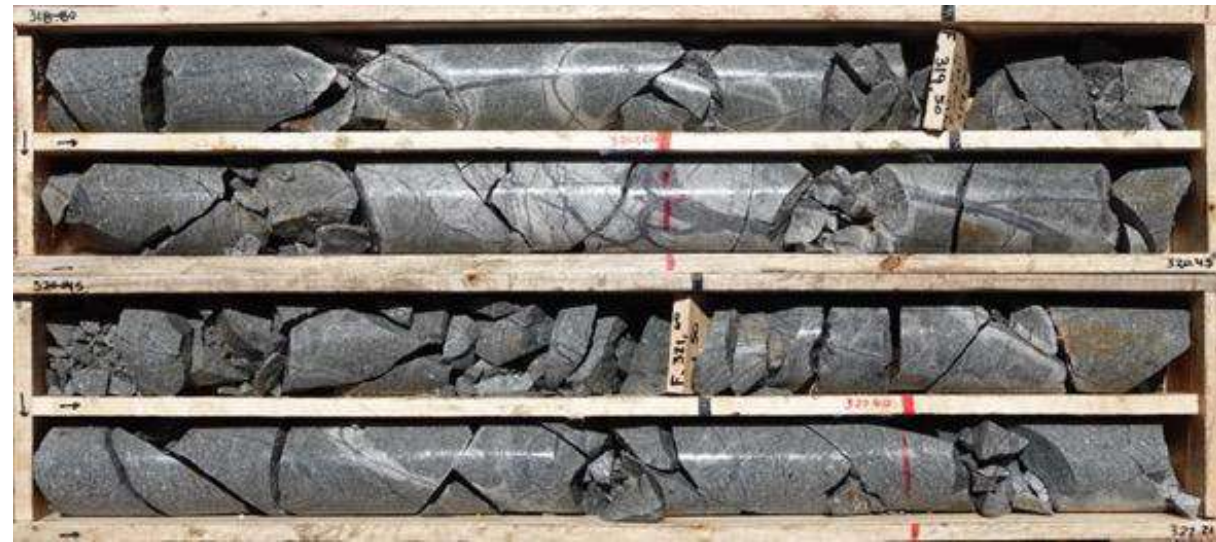
Hole PIU06: Chalcopyrite-chalcocite-pyrite sulfide assemblage
